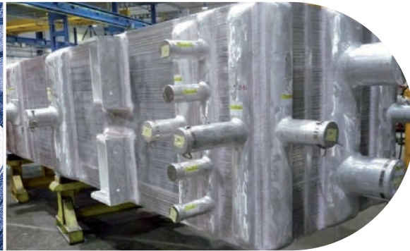
Mid-scale LNG plant - Air Liquide Brazed Aluminium PFHE
